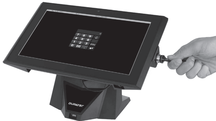
Abb. 16: Bedienschlüssel an das Bedienschloss halten
