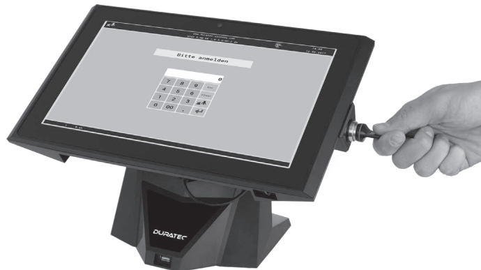
Abb. 17: Bedienschlüssel an das Bedienerschloss halten
