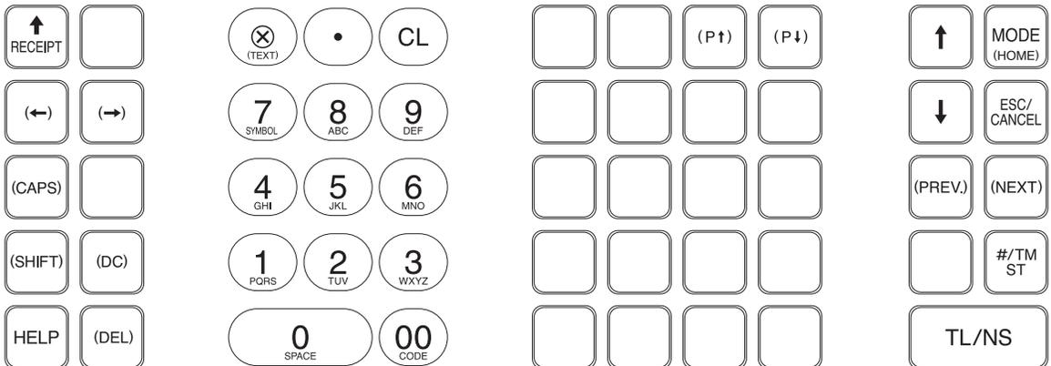
(SHIFT) (DC) (DEL) (CAPS) (SPACE) (TEXT) : Verwendet zur Programmierung von Zeichen. Nähere Informationen über das Programmieren von Zeichen sind dem Abschnitt „Alphanumerische Zeichen programmieren“ zu entnehmen.
