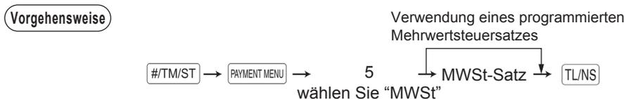
Dieses System ermöglicht die MWSt-Berechnung für die aktuelle Zwischensumme. Die Berechnung erfolgt anhand des programmierten MWSt-1-Prozentsatzes, wenn unmittelbar vor der Auswahl von „MWSt“ aus dem Zahlungsmenü die #/TM/ST-Taste gedrückt wird. Bei diesem System wird der über die Tasten eingegebene Steuersatz verwendet.
