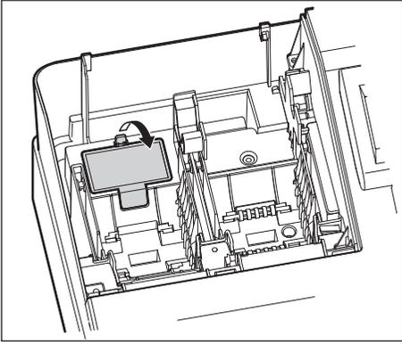
3. Öffnen Sie den Batteriefachdeckel, und entfernen Sie die alten Batterien.
