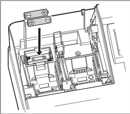
4. Setzen Sie zwei neue LR6-Batterien (Größe „AA“) in das Batteriefach ein.
